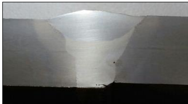
Figura 37 - Macrografia da Junta preliminar GMAW-RE
