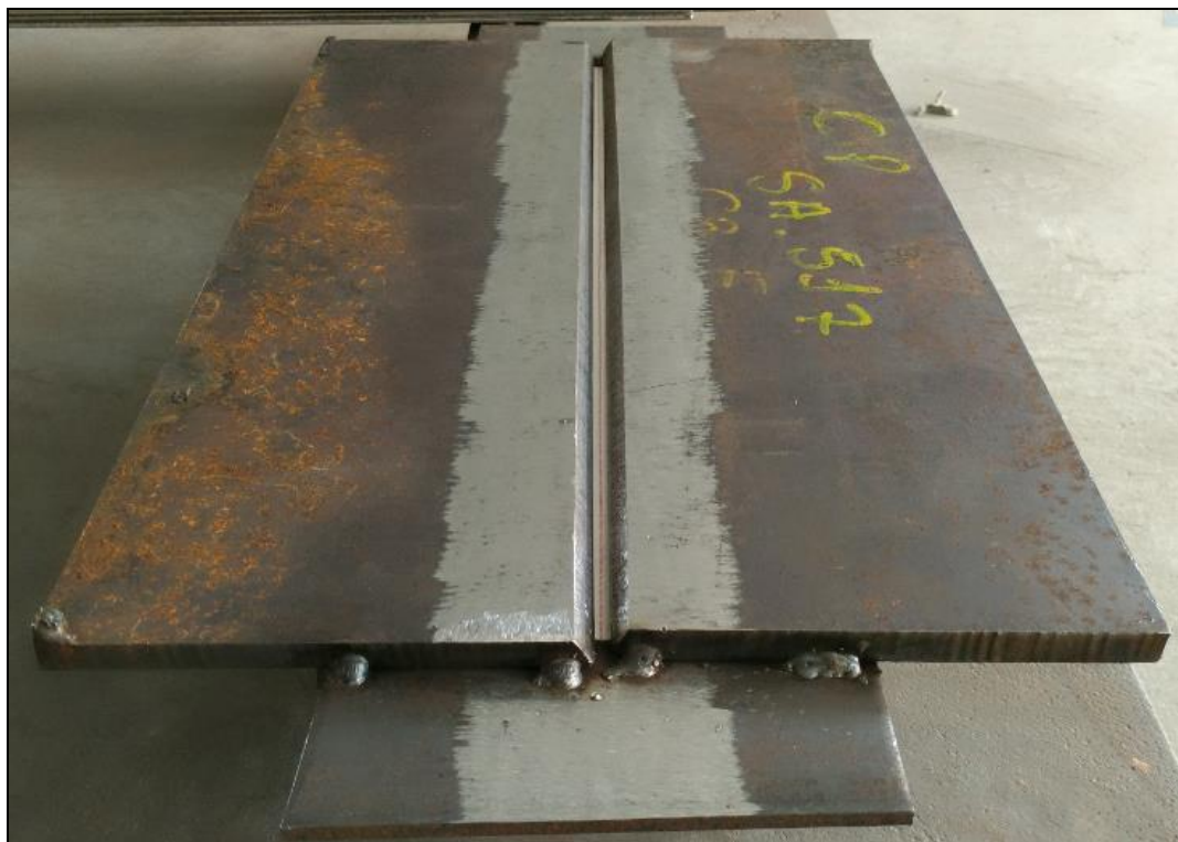
Figura 26 - Junta Convencional montada
