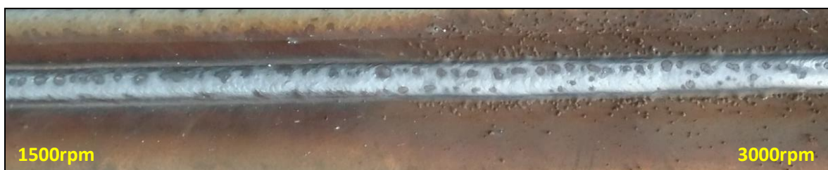
Figura 48 - Projeção dos respingos em função da frequência de rotação. Esquerda: 1500rpm / Direita: 3000 rpm
