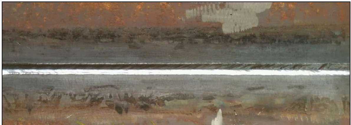
Figura 38 - GMAW convencional: Aspecto Visual do passe de raiz
