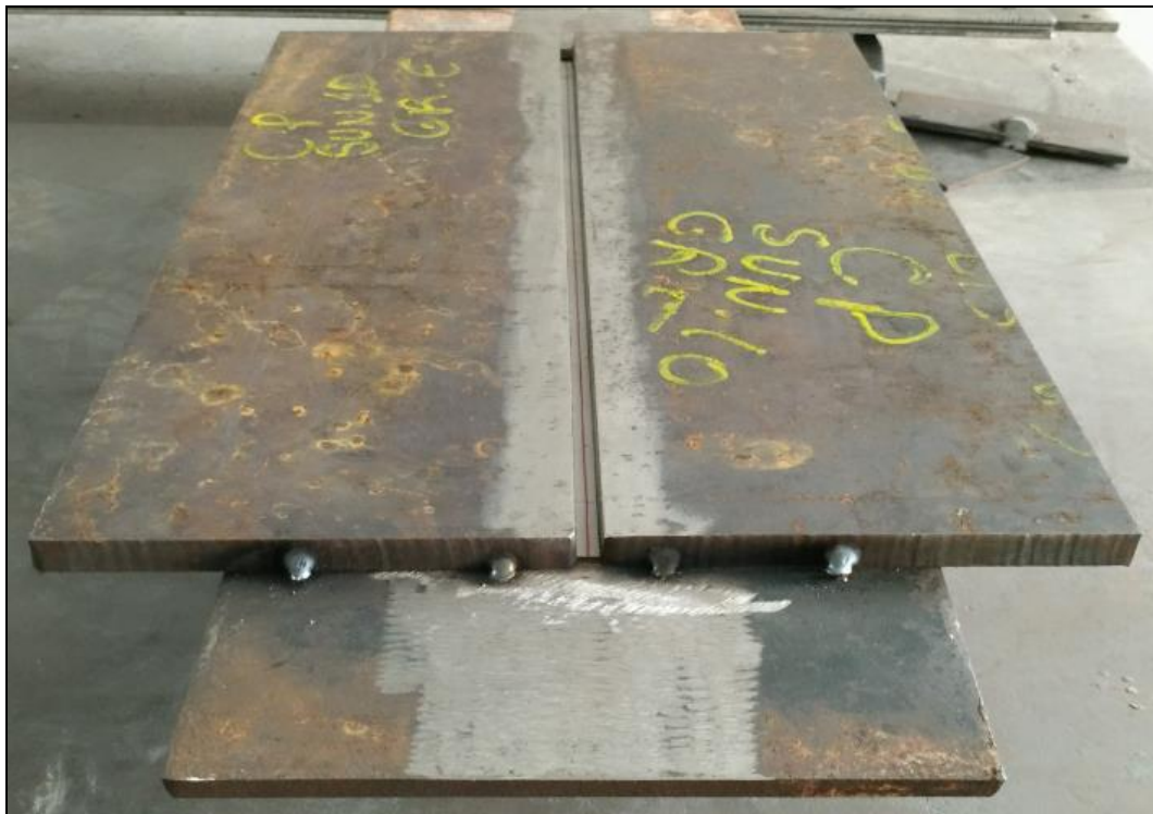
Figura 28 - Junta em chanfro reto montada
