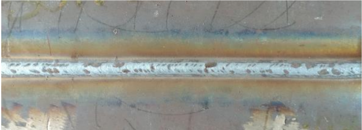
Figura 41 - GMAW-RE: Aspecto visual do passe de acabamento. Sem limpeza
